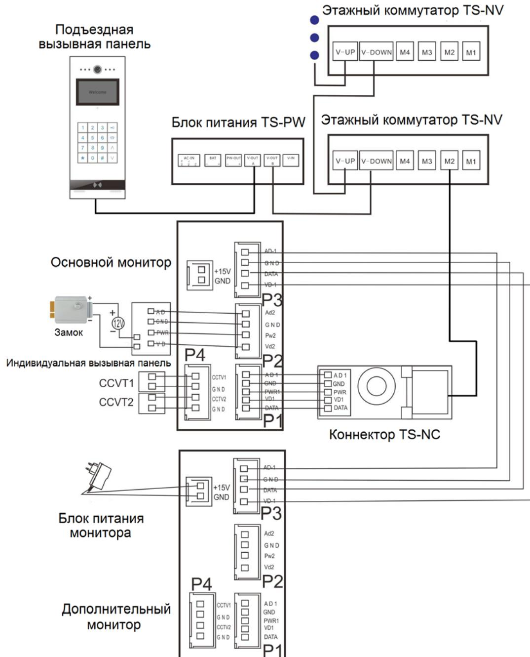
**Внимание:** от системы могут быть запитаны следующие мониторы: серия LILU, серия Slim, серия Tango, Sherlock, Stark, а также трубка TS-AD Tantos. Возможное количество подключаемых мониторов и этажных коммутаторов к одному TS-PW, смотри в таблице, в инструкции на блок питания TS-PW.
